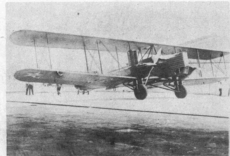
Nouveau Type de Biplan, Avion de Bombardement en Amérique. Ce nouvel avion Martin, tout en métal, est équipé de six canons et peut transporter à bord cinq personnes et une charge de 1200 kilos.
