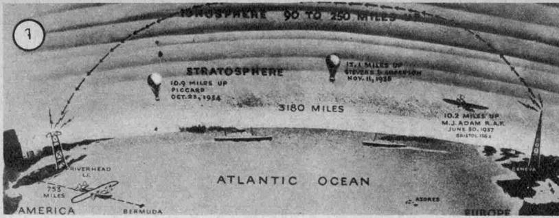
1. Schema, wie eine Uebertragung aus Europa nach Amerika vor sich geht. Die Sendung wird hier in Genf per Kurzwellenausgestrahlt, durch die Ionosphäre geschickt und in Riverhead empfangen.
