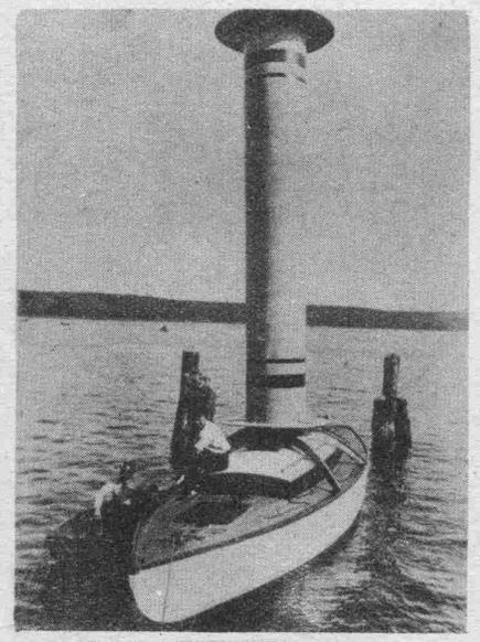
Der Ingenieur FLETTNER hat ein neues Boot, den «Rotor» konstruiert, bei dem die Segel durch grosse rotierende Blechsäulen ersetzt werden.
