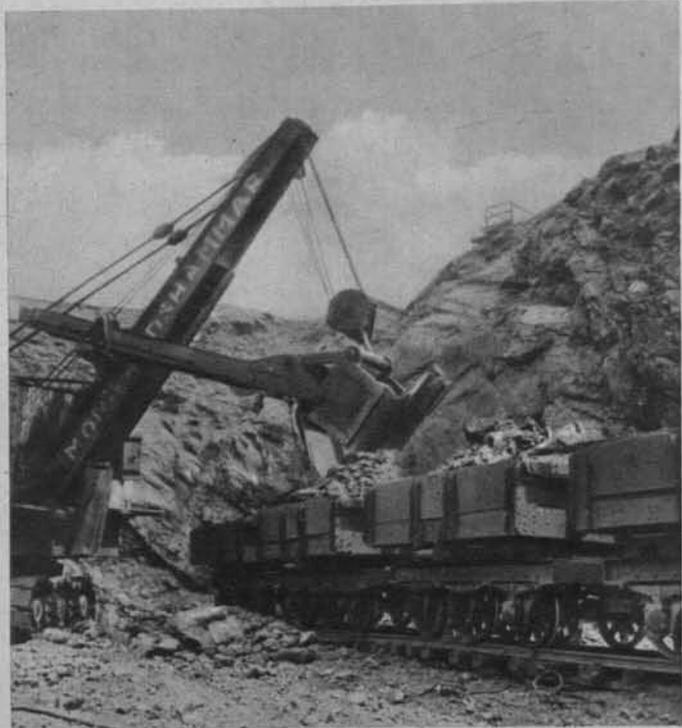
Mit mächtigen Kranen wird das Erz auf Eisenbahnwagen verladen und nach der Erzmühle gefahren.
