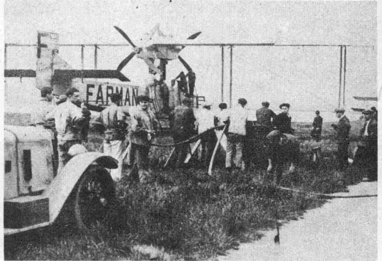
Au Bourget „l'Oiseau Bleu" a fait des essais de décollage avec des charges progressives. Notre photo montre le plein d'eau qui remplace l'essence pour les essais.
