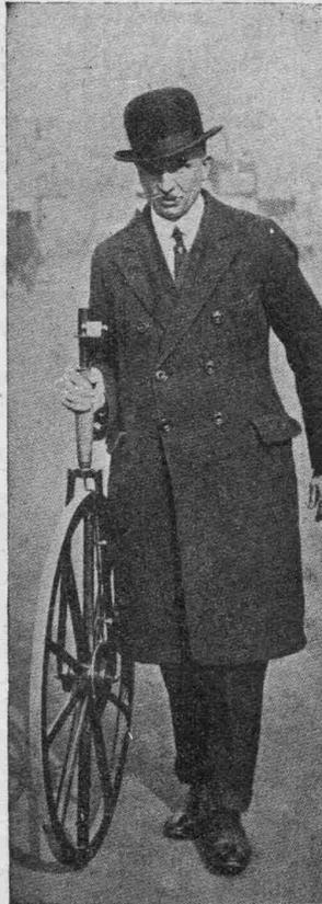
Ein praktischer Meter, der auf einem Rad aufmontiert ist, findet in London bei Strassenvermessungen Anwendung.
