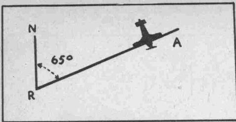
Radiogeometrische Bestimmung. A: Flugzeug, N: Norden, R: Radiostation. Auf der Station R beträgt der Winkel  $65^\circ$ .
